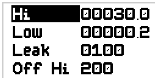
Рисунок Е.11 – Установка предельных значений по току
